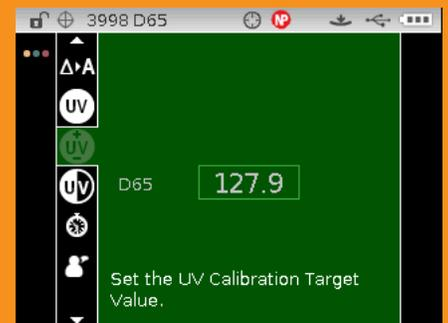
Componente UV calibrato - è il primo spettrofotometro portatile X-Rite con componente UV regolabile per caratterizzare completamente materiali trattati con sbiancanti ottici
